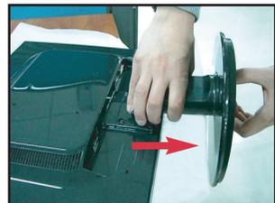
5. Ziehen Sie das Ständerteil leicht, um es vom Scharnier zu lösen.
